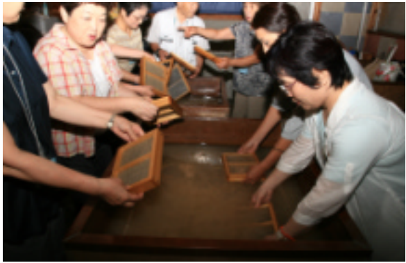
厚みが均一になるように手元に集中し、引き上げるタイミングをはかる
